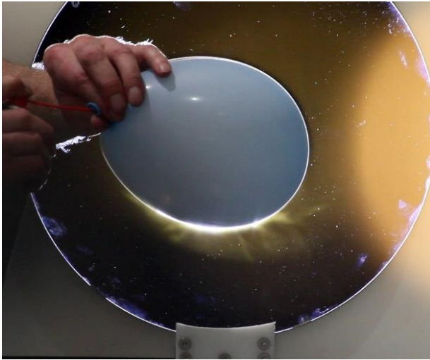
Abb. 6: Ballon gefüllt mit Kaltgas. Man sieht die Abströmung der sich abkühlenden Luft um den Ballon nach unten.
