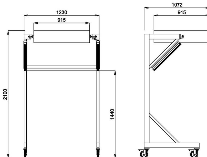
Die Abb. zeigt die Dimensionen der Ausführung mit den Filtern der Größe 915 x 915 mm. Die Ausführung mit den Filtern 1200 x 1200 mm wird flächenmäßig entsprechend größer
